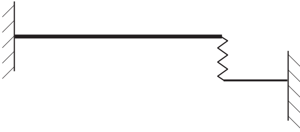
Рис. 1. Кантилевер (слева) и наностержень (справа).
